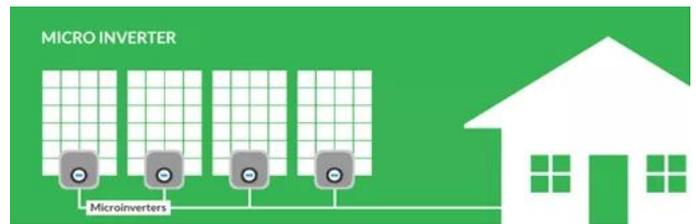
Le **micro-onduleur**, commode notamment pour les petites installations, s'installe directement sur le toit, sous un panneau photovoltaïque, il est directement connecté au panneau solaire. Chaque panneau photovoltaïque possède son micro-onduleur.
