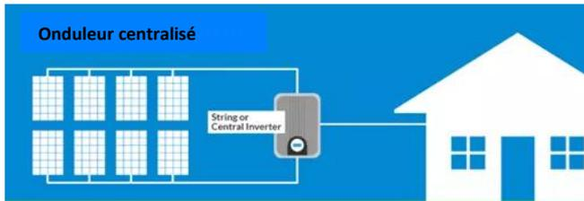
L'**onduleur centralisé** est un appareil électronique de puissance qui se branche en série. Cela signifie qu'un seul onduleur solaire est installé pour gérer tous les panneaux photovoltaïques fixés sur la toiture. L'onduleur centralisé s'installe à côté du compteur électrique.
