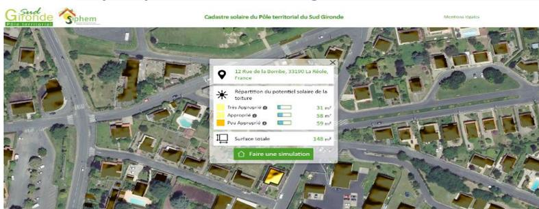
Ensoleillement annuel optimal des modules photovoltaïques
